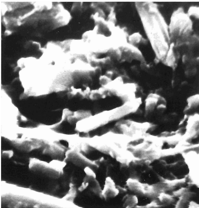
Foto n. 12 - Superficie di alterazione del campione n. 1 (Tessera inv. 326) in cui si distinguono forme cristalline neoformate, e che costituiscono un fitto feltro (ingr.: 1 cm = 80 micron).
